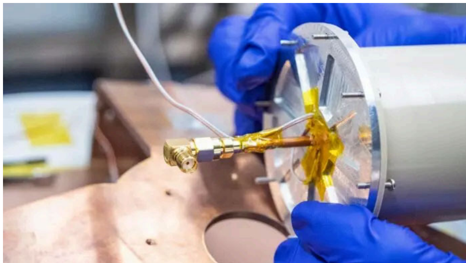
A antena foi probada en baleiro e a temperaturas extremas. Foto: DUVI
